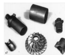
Примеры изделий из титановых сплавов, полученных изотермической (высокоскоростной сверхпластической) штамповкой: диски компрессора, «блиск», стаканы, гильзы, корпуса, лопатки и др.
