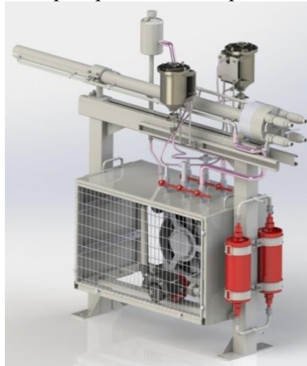
Детонационная установка Импульс-М3 (в стационарном исполнении)
