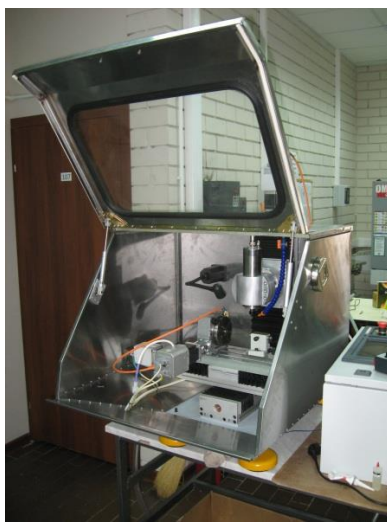
Специализированное металлорежущее оборудование для часовой промышленности – зубофрезерные и фрезерно-гравировальные станки
