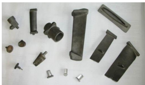
Примеры изделий из титановых сплавов, полученных изотермической (высокоскоростной сверхпластической) штамповкой: диски компрессора, «блиск», стаканы, гильзы, корпуса, лопатки и др.
