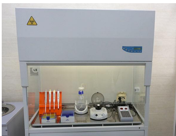
Ламинарный шкаф с набором оборудования для выделения ДНК
