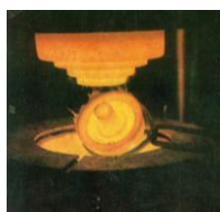
Примеры изделий из титановых сплавов, полученных изотермической (высокоскоростной сверхпластической) штамповкой: диски компрессора, «блиск», стаканы, гильзы, корпуса, лопатки и др.
