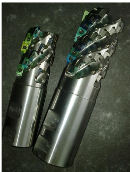
Фрезы со сменными пластинами с нанесенным наноструктурным углеродным алмазоподобным покрытием
